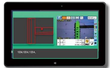
鉄骨建て方支援システムは、Nivo-i の正確な座標管理機能と、高倍率ライブビュー画像を用いて、鉄骨を設計通りに組み立てる業務を効率化するシステムです。Nivo-i の AR (拡張現実) 機能を使い、設計データと実画像を重ね合わせて一括表示、現在位置と設計データの差異を画像上で確認できますので、現場での即時調整とオフィスでのモニタリングが可能です。 (※鉄骨建て方支援システムは今秋リリース予定)
